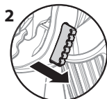
Gatillo desbloqueado (la pistola sí pulveriza)
