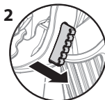
Gatilho desbloqueado (a pistola pulveriza)
