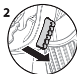
Détente débloquée (le pistolet pulvérise)
