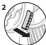
Abzug entriegelt (Spritzpistole sprüht)
