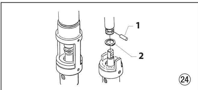
9. Die Kolbenstangenbaugruppe vom Motoren-/Pumpenblock (31) entfernen.
